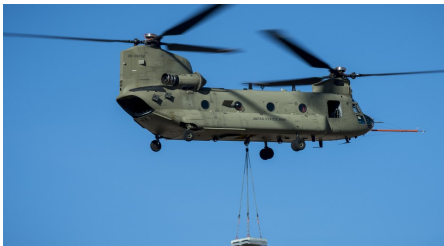
Figura 5 – CH-47 Chinook, Rotor Tipo Tandem
