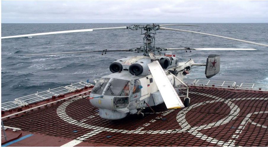
Figura 3 – Kamov Ka-27 Helix, Rotor Tipo Duplo Coaxial.
